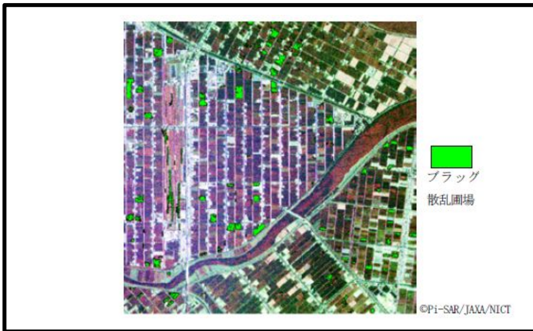
<그림 28> Even성분과 VV/HH의 편파비 이용한 Bragg 산란포장 추출
