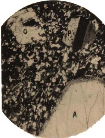
O 橄欖石ノ斑晶、A 輝石ノ斑晶、P 斜長石ノ斑晶、
