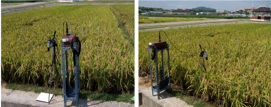
<그림 3.1.2-3> 휴대용 분광복사계를 이용한 현장 반사율 측정
