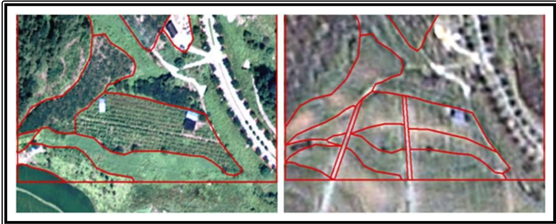
<그림 4-16> 아리랑 2호 영상을 활용한 현행화(좌: 2009/08 항공사진 현행화 전 , 우: 2011/05 아리랑2호 영상 현행화 후)
