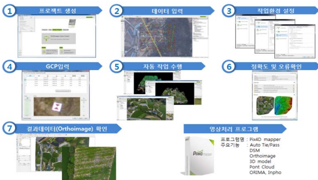
<그림 4-14> PIX4D MAPPER를 이용한 데이터 처리방법
