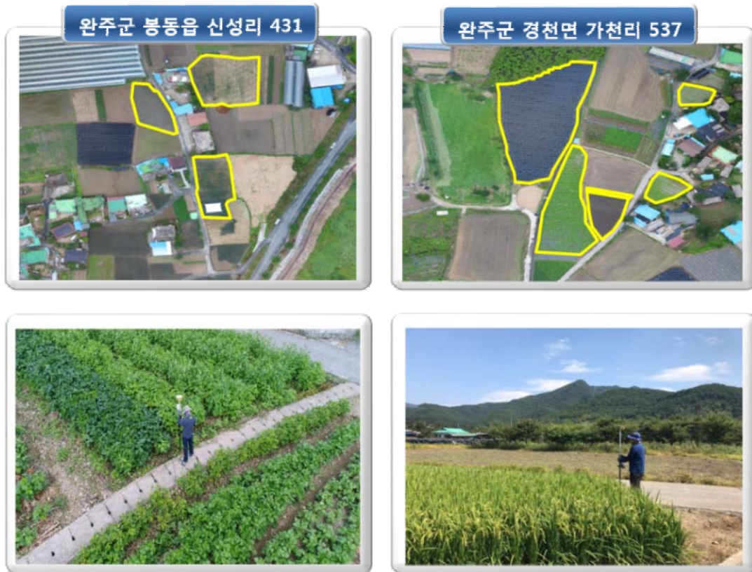
<그림 3-23> Network RTK를 이용한 현장실측
